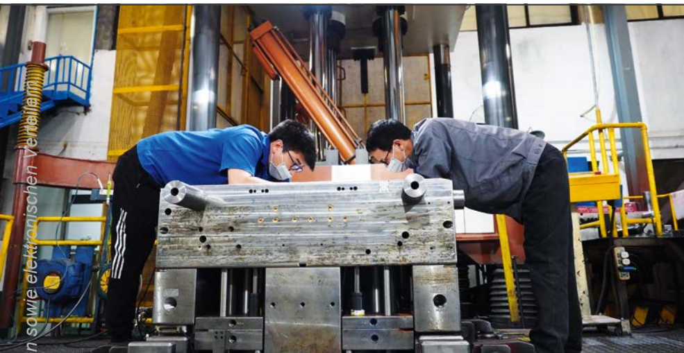
Finishing an der Tuschierpresse: Bei Silver Basis werden Werkzeuge für alle sichtbaren Teile im Pkw-Innenraum gefertigt. (© Hanser/Schröder)
